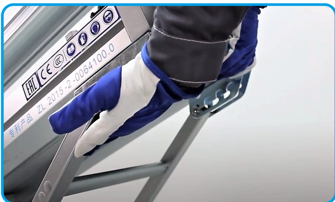
2) Поднимите станок с одной из сторон, руки должны находиться снаружи станка и не попадать между опорой и корпусом стола. Двигатель должен быть зафиксирован или находиться в крайнем положении в противоположной стороне от места подъема.
