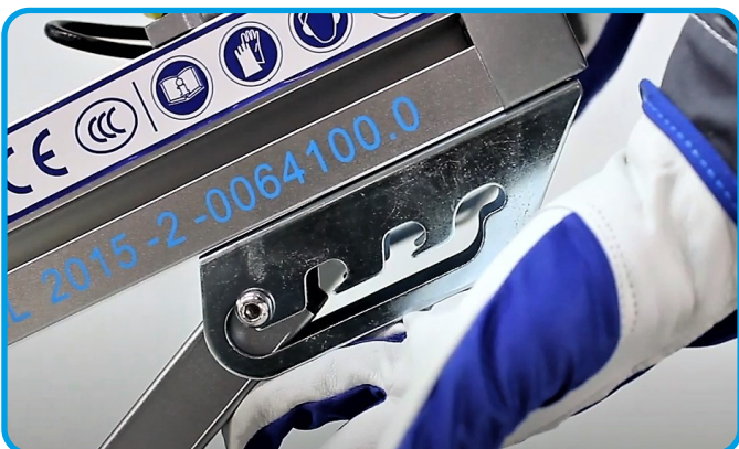
3) Подтяните опору снизу, чтобы стопор попал в фиксирующий паз. Проверьте попал ли стопор в паз с другой стороны. Если нет, подтяните его.
